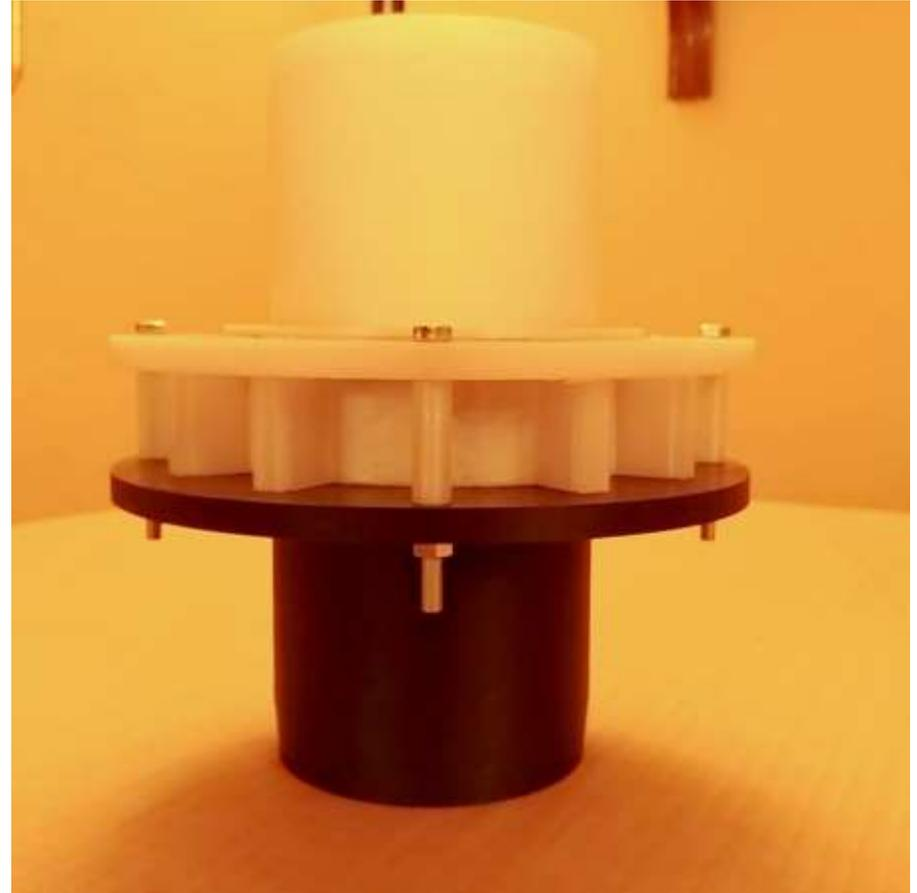
*Prima di fare le prove con l'acqua, le testate sono state distanziate, in quanto, nonostante il fissaggio con la colla, sono ancora presenti asimmetrie che decentrano il rotore facendolo appoggiare allo statore.*
